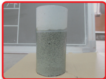
写真-4 IFゼロセメント供試体
