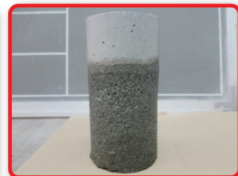
写真-6 IFゼロセメント供試体
