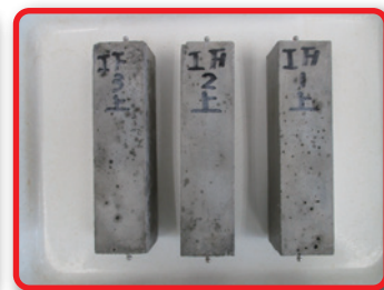
写真-2 IFゼロセメント供試体
