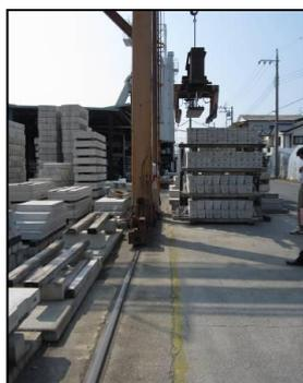
大型クレーンの通り道に黄色のラインを引き、製品出荷の車両に目からも注意を促せるようになった。
