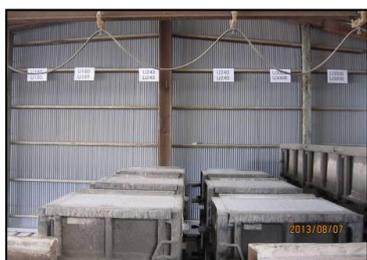
複数の型枠を整理し、表示を取付け明確にすることによって、移動・作業効率を短縮させた。
